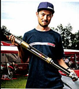
caratteristiche del telaio. Sulla manutenzione, la raccomandazione è simile alle forcelle convenzionali, ciò che chiediamo ogni sei ore è di fare pulizia; tenute e bussole, invece, come con la molla. Certo, se la tenuta perde, va sostituita, ma normalmente non è necessario.
