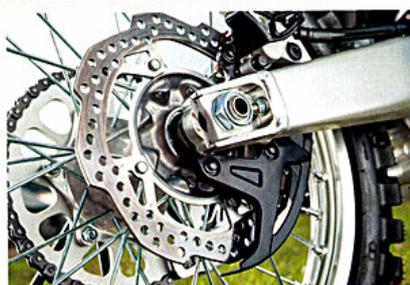
**DISCO ANTERIORE.** Cresce il diametro del disco freno delle CRF che dopo anni a 240 mm (eredità CR), passa a 260, con profilo a margherita; il posteriore rimane da 220. **MOLLA LEGGERA.** Cambiano materiale e struttura della molla Showa sulla CRF 250 che mantiene la stessa costante elastica ma scende di peso.
