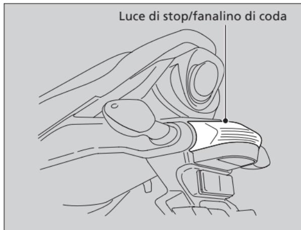
La luce di stop e il fanalino di coda utilizzano diversi LED. Se un LED non si accende, fare eseguire la riparazione presso il concessionario.
